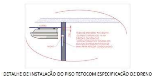
FIGURA 9: DETALHAMENTO DO SISTEMA DE DRENO HI WAL FIGURA 10: DETALHAMENTO DO SISTEMA DE DRENO PISO TETO
